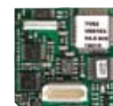
FVP-35 Moduł szyfrujący (kod dynamiczny)
